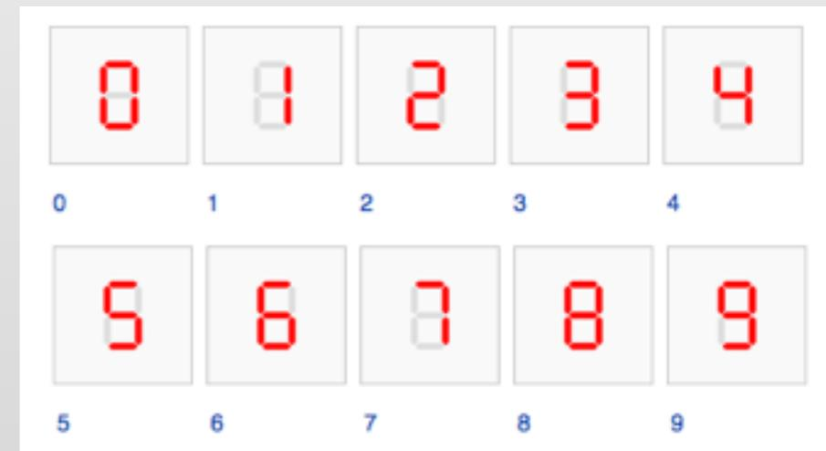
Q: l'afficheur à 7 segments pour les chiffres décimaux codés **en ASCII** :
